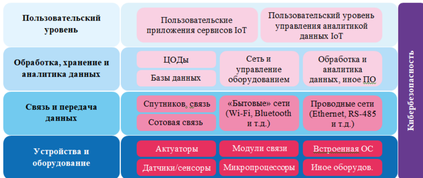
Рис. 1. Типовая архитектура IoT-систем
