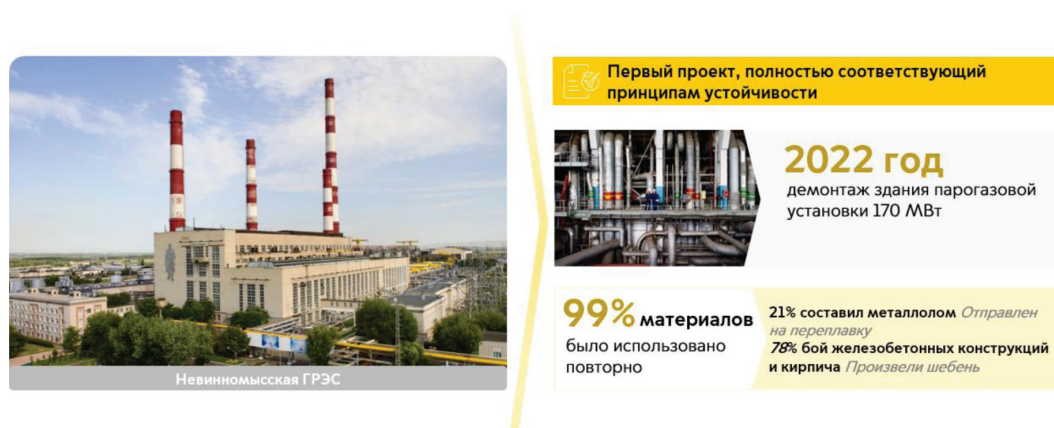
Рис. 4. Детали проекта по демонтажу здания парогазовой установки на Невинномысской ГРЭС Источник: составлено авторами на основе [11;12]
